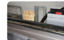
Scorrimento del ponte (asse Y) su guide lineari a riciclo di sfere in bagno d'olio / Bridge Sliding (Y axis) on recirculating ball linear guides in oil bath
