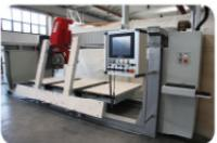
Banco ribaltabile pneumatico (portata kg 800) o idraulico (portata kg 3500) per carico e scarico materiale
