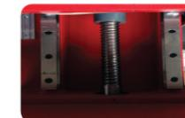
Movimento asse Z con vite e chiodella a riciclo di sfere / Z axis moved by screw and recirculating ball leadnut
