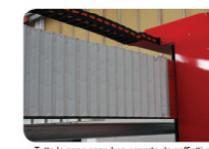
Tutte le zone sono ben coperte da soffietti e carter protettivi in acciaio contro polvere e acqua / All the parts are well-covered by bellows and protective steel covers against dust and water-spray
