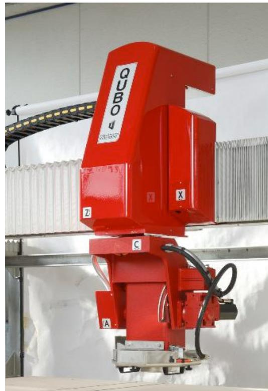
Zur Technologie, Qubo, abgesehen vom niedrigen Preis, besitzt sie die gleichen hochwertigen Komponenten von „SFERA“, wie die lineare Führung und den schnellen bürstenlosen Motoren für die axiale Bewegung. Alle 5 Achsen werden CNC gesteuert. Die Maschine ist manuell sehr leicht zu bedienen aufgrund der Benutzung eines Bedienteiles mit Druckknöpfen, Reglern und Touchscreen. Mit der leicht bedienbaren CAD-CAM Software ist es möglich die Maschine im Automatik-Modus zu programmieren.
