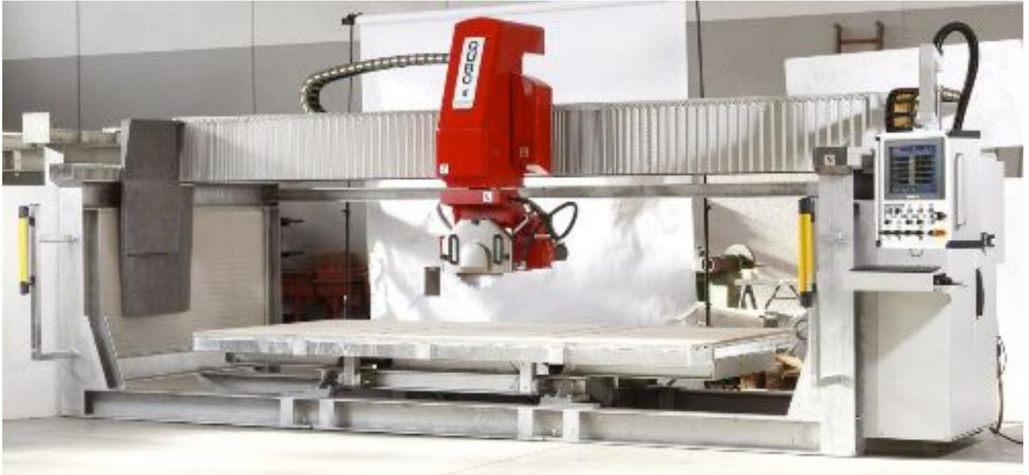
Tatsächlich wird „Qubo“ bei „Noat“ vor der Auslieferung zum Endkunden komplett montiert. Dank der „MONOBLOCK“-Struktur welche aus verzinkten Stahlschultern besteht, benötigt unser Techniker weniger als einen Tag um die Maschine vor Ort (in der Kundenwerkstatt) zu installieren.
