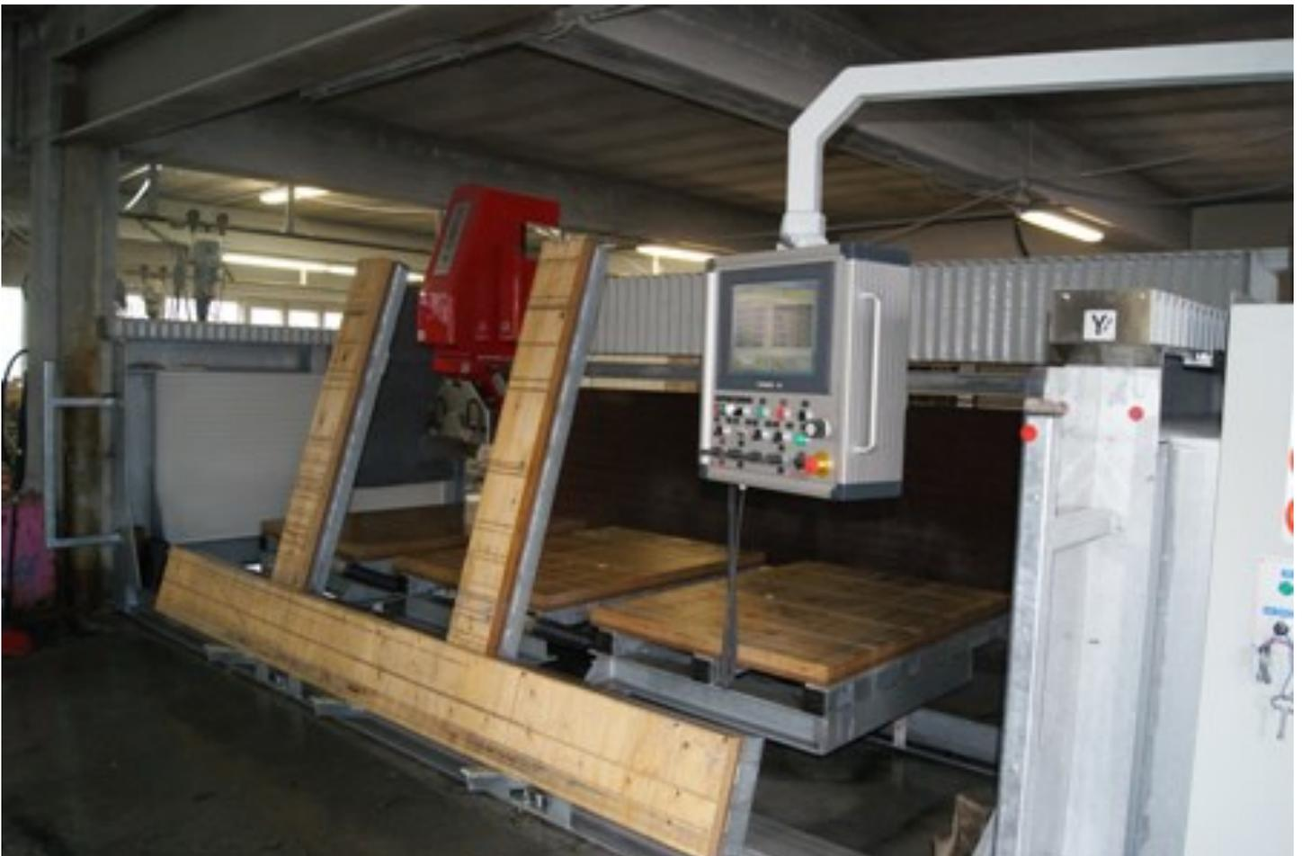
Außerdem ist die Maschine mit einer Klimaanlage ausgestattet welche eine konstante Temperatur im Schaltschrank ermöglicht
