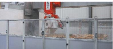
Abdeckung mit kratz-und abriebfesten Polycarbonat-Platten, die den Bediener vor Spritzwasser schützt
