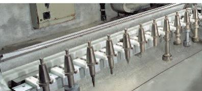
Werkzeughalter in einer linearen Position für den automatischen Werkzeugwechsel
