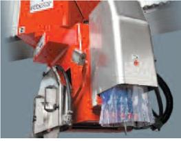
Zweite Elekterspindel mit variabler Geschwindigkeit bis zu 10000 U / min für den Einsatz mit Diamond Tools auf einem ISO 40 Kegel mit pneumatischer Auslösung montiert
