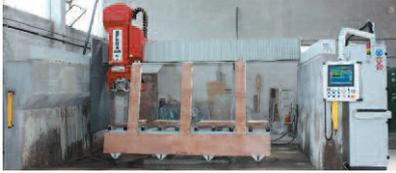
Hydraulischer Kipptisch für Be- und Entladen des Materials (Kapazität 4000 kg)
