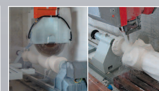
14. Lavorazioni di colonne su Tornio CNC Machining of columns on CNC lathe Usinage de colonnes avec tour à CN Bearbeitung von Nuten auf CNC-Drehmaschine
